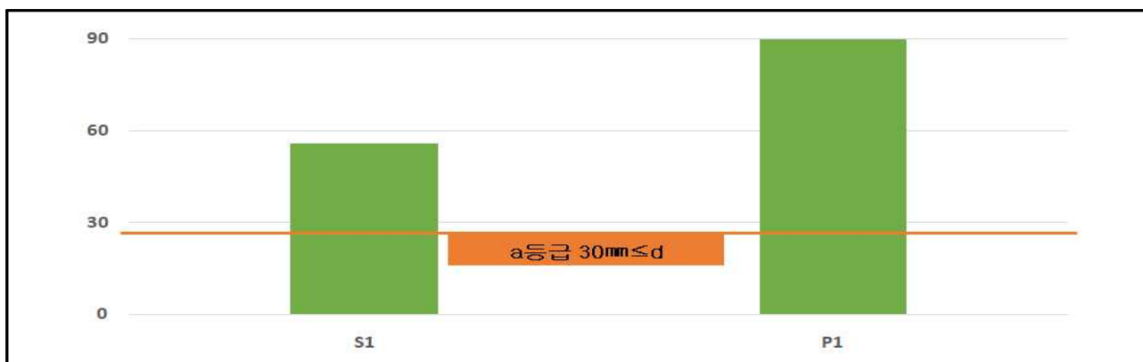
【그림 3.11】 탄산화 깊이 측정결과
